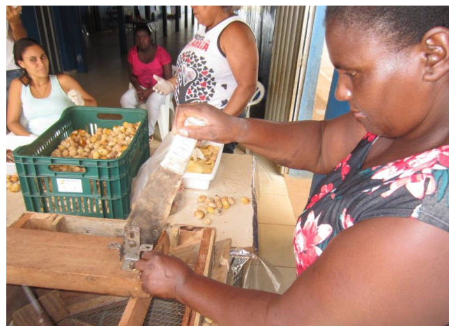
Castanha cristalizada, in natura e guilhotina adaptada por associado para extração da castanha
